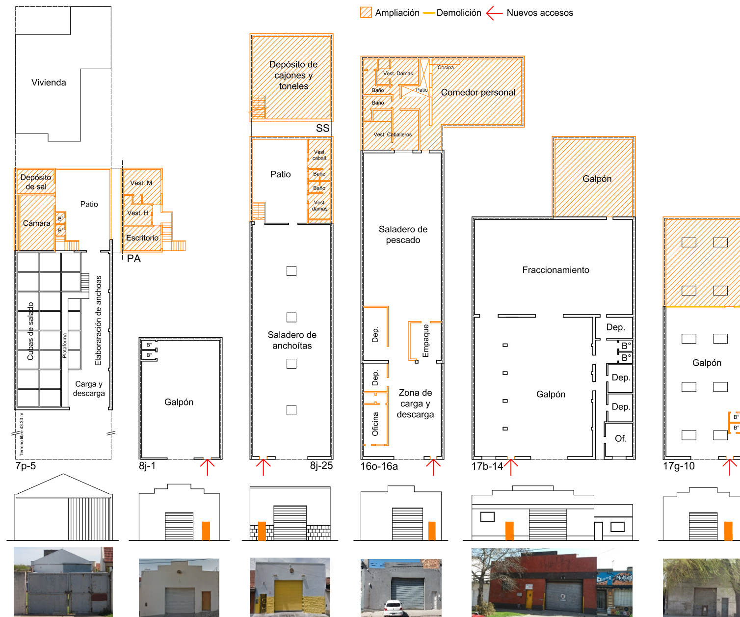
Figura 3.19: Transformación de los saladeros (Fuente: elaboración propia en base a los planos de los expedientes del Archivo de Obras Privadas de la MGP y relevamiento in situ en diciembre de 2020). Escala 1:400.
